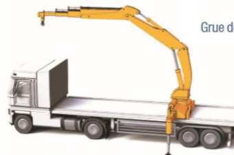
Grue de chargement montée en position centrale
