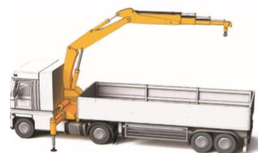
Grue de chargement montée derrière la cabine
